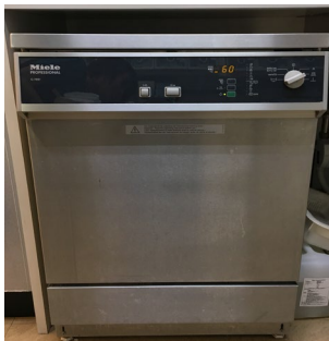
洗浄（自動洗浄機）
